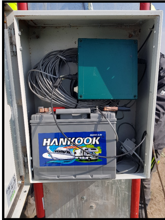
Photo n° 1 : détecteur d’ultrasons dans son coffret.
